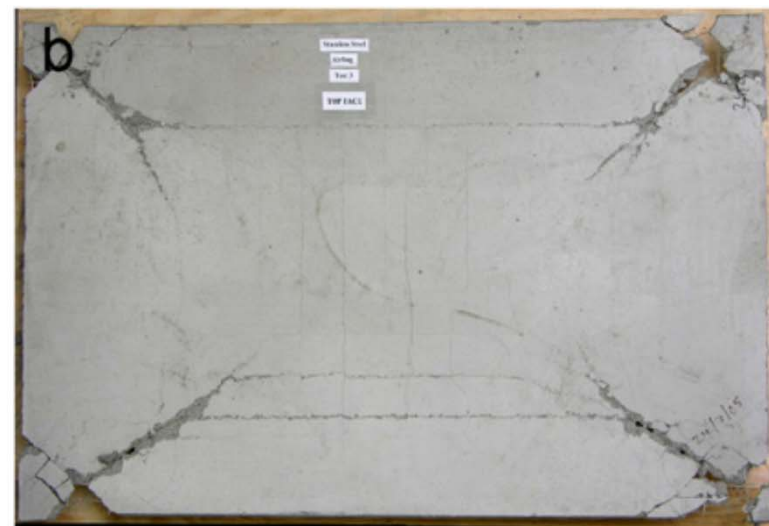
Tlakové porušení betonu
