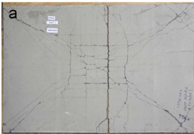
Tahové porušení výztuže
