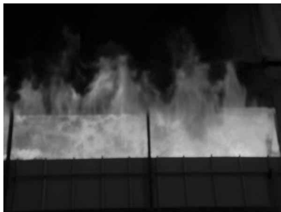
Obr. 41 Pohled na požární úsek ve 39. min plně rozvinutém požáru
