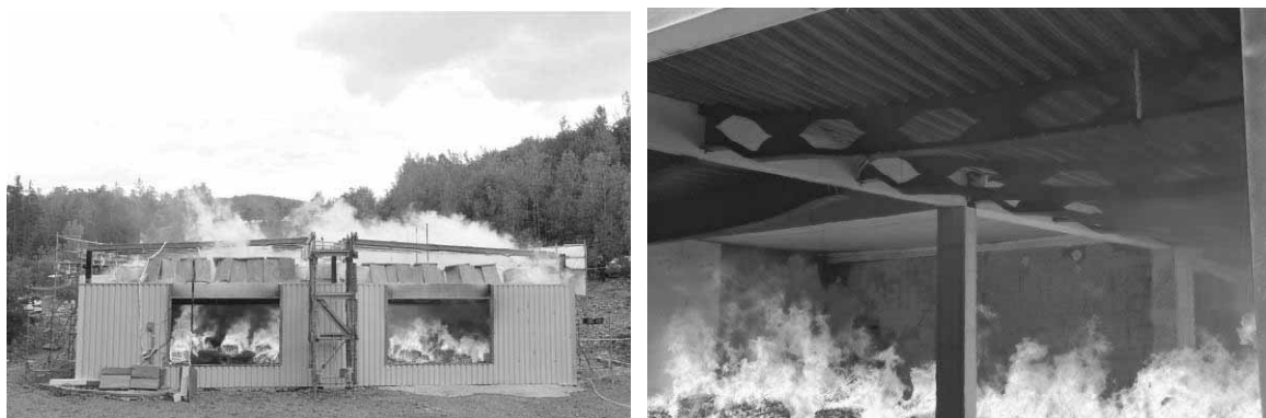
Obr. 55 Pohled na objekt při plně rozvinutém požáru
