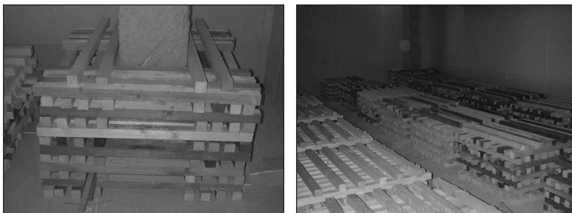
Obr. 39 Požární zatížení dřevěnými hranoly ve 32 hranicích
