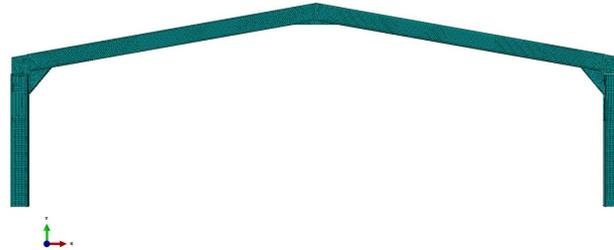
Fig. 21.7 FE Shell idealisation Mesh
