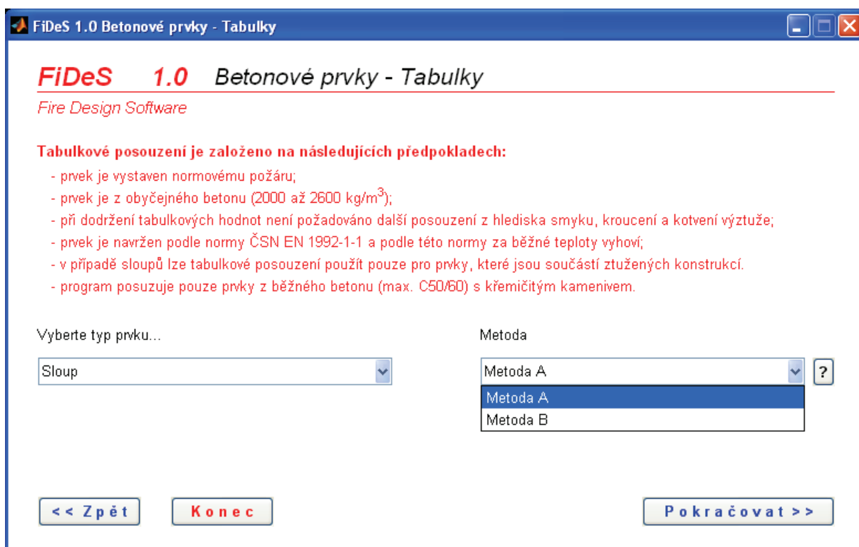
Obr. 4.2 Úvodní okno programu pro posouzení požární odolnosti betonových prvků pomocí tabulek uvedených v normě ČSN EN 1992-1-2 [4.2]
