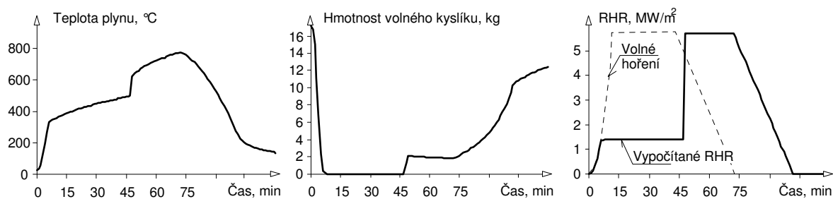
Obr. 11.21 Teplota plynu, hmotnost volného kyslíku a rychlost uvolňování tepla pro požár řízený ventilací s postupným uvolňováním okenního otvoru při 300^\circ\text{C} a 500^\circ\text{C} , požární zatížení 750 \text{ MJ/m}^2 , pro požární úsek při zkoušce v Ostravě 2006 s dvěma okny
