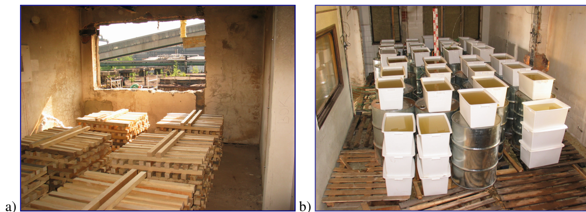
Obr. 4 a) Požární zatížení dřevěnými hranoly 50 x 50 x 1000, b) Mechanické zatížení barely s vodou
