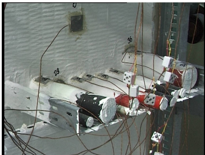
Obr. 3.3 Rozmístění termočlánků na zkušebním vzorku
