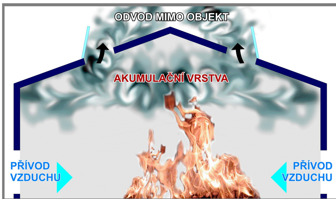
Obr. 7.2 Princip činnosti zařízení k odvodu tepla a kouře
